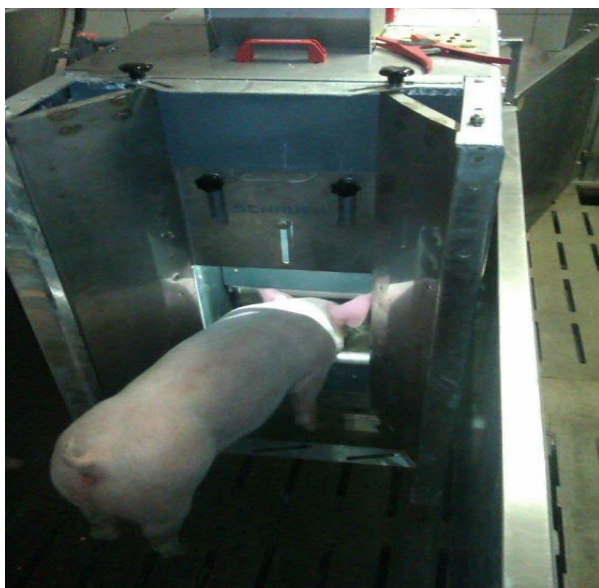
Figur 1. Foderstation (BIAS) fra BoPil, hvor det er registreret af stationen, at grisens transponder er tilknyttet stationens software, hvorfor stationens dør er åbnet og tillader grisen at æde. I bunden af truget er der vejeceller, der vejer foderet før og efter en gris har besøgt foderstationen.
